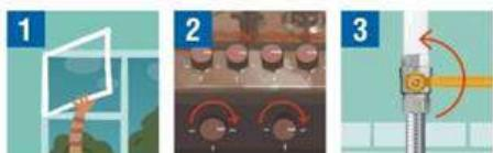
2. Зажженную спичку нужно поднести к горелке, затем открыть кран включаемой горелки, при этом газ должен загораться во всех отверстиях горелки.
